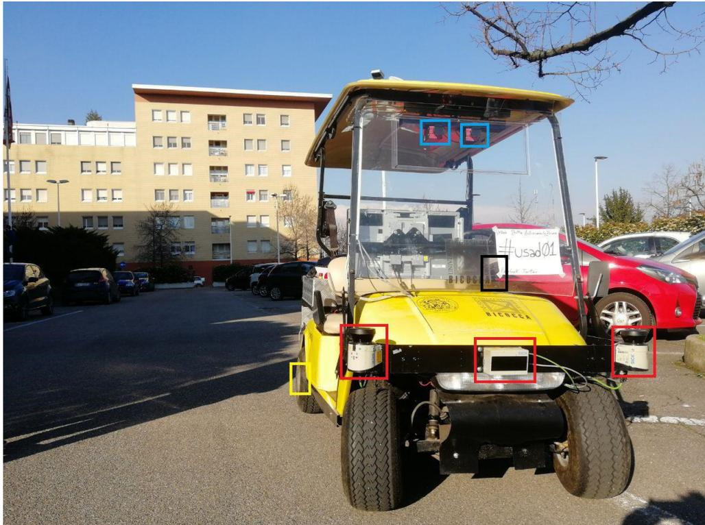
Figura 2.1: Veicolo USAD con rappresentati i sensori. In azzurro le due camere anteriori, in rosso i tre lidar montati sempre anteriormente, in giallo due encoder montati sulle ruote posteriori, in nero il motore montato sullo sterzo.
