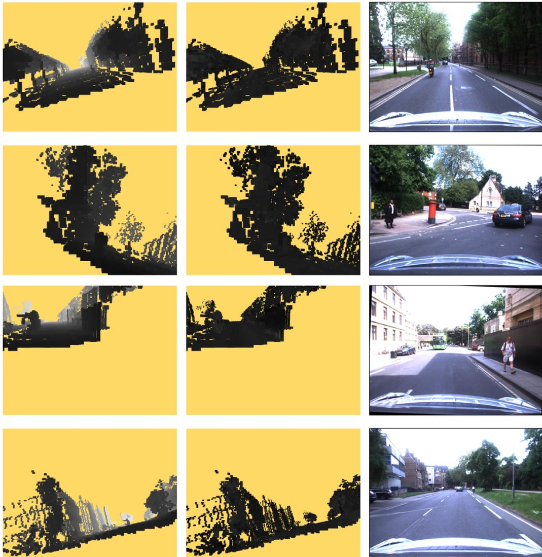
Figura 4.11: In figura vengono mostrati degli esempi di immagini ottenute dal dataset acquisito il 19 maggio. In particolare, da sinistra vengono mostrate le immagini di: profondità, riflettanza e RGB. L'errore aggiunto sulla pose iniziale è compreso nell'intervallo  $[-1.5m, 1.5m]$  per le traslazioni e  $[-20degs, +20degs]$  per le rotazioni. Il lato del voxel delle mappe generate ha dimensione che si aggira intorno ai  $30cm$ .
