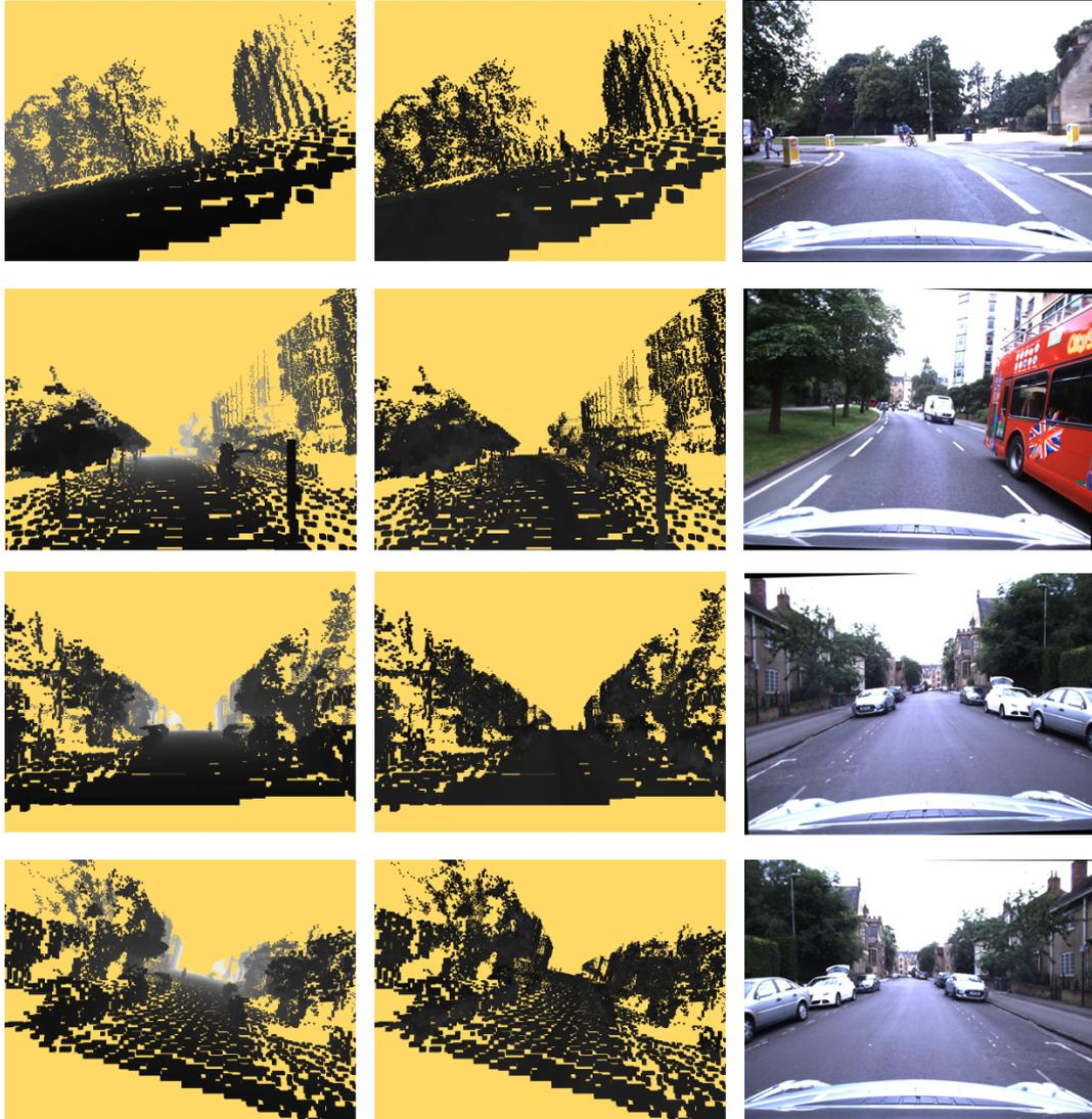
Figura 4.13: In figura vengono mostrati degli di immagini generate partendo dal dataset del 26 giugno. L'errore iniziale sulla pose camera è compreso nell'intervallo  $[-1.5m, +1.5m]$  per le traslazioni e  $[-15degs, +15degs]$  sulle rotazioni.
