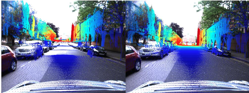
Figura 4.3: A sinistra viene mostrata la proiezione della mappa ottenuta mediante il dato GPS, mentre a destra viene mostrata la casistica in cui vengono utilizzate le pose ricavate dalla *visual odometry*.
