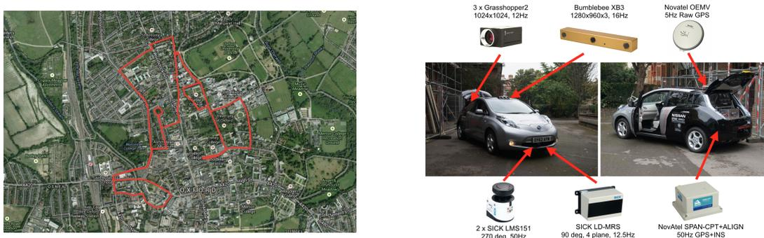
Figura 4.2: A sinistra vengono mostrati i diversi percorsi effettuati durante le fasi di acquisizione del dataset, a destra viene raffigurato il veicolo utilizzato insieme al sistema di sensoristica.
