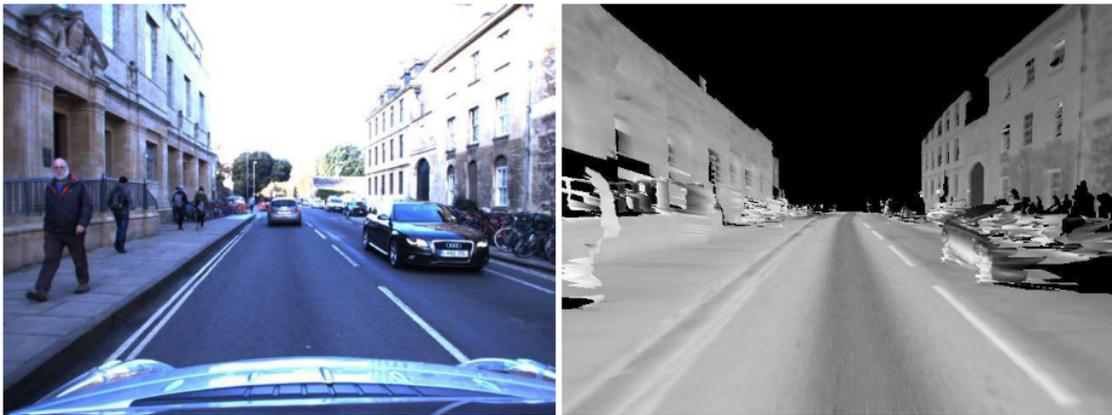
Figura 2.15: A sinistra l'immagine RGB rappresentante una strada. A destra la corrispondente immagine LiDAR ottenuta mediante l'approccio a mesh.
